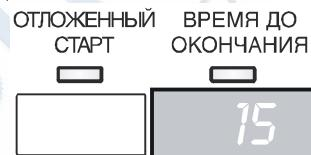
Если была нажата кнопка **ЗАМАЧИВАНИЕ**, выбранная задержка пуска будет соответствовать времени замачивания. Если задержка пуска выбрана не была, программа замачивания будет длиться около 30 минут.
